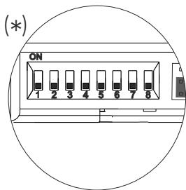
El microinterruptor de configuración está ubicado en el lateral superior derecho de la parte posterior de la placa.
