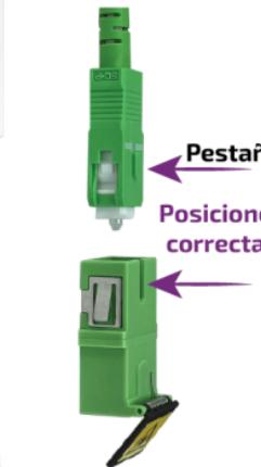
3 Deslice el adaptador hacia el interior del FTB-KL90 hasta el fondo. El adaptador debe quedar anclado.
