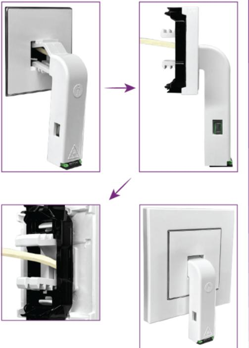
5 Si necesita extraer el adaptador SC, presione las pestañas metálicas laterales simultáneamente y tire del adaptador hacia abajo.
