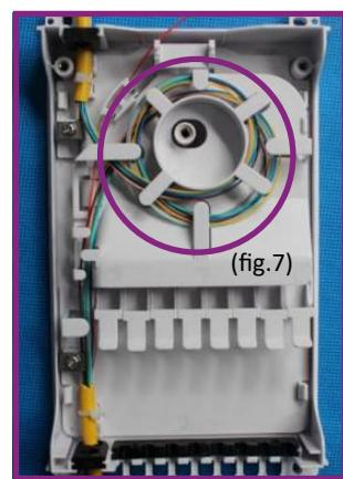
Para la instalación de cable en paso hacer un sangrado del cable principal. Se recomienda entre 50 -90 cms.
