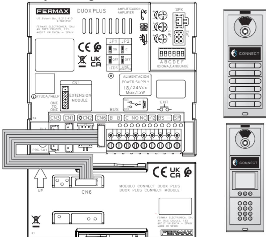
**NOTA:** Se recomienda ubicar el módulo CONNECT justo debajo del módulo Amplificador DUOX PLUS. No obstante, si necesita un cable más alargado para ubicarlo en otra posición, puede adquirir aparte la referencia F02546. **Este cable tiene 29cm y permite conectar el módulo CONNECT en otra ubicación.**
