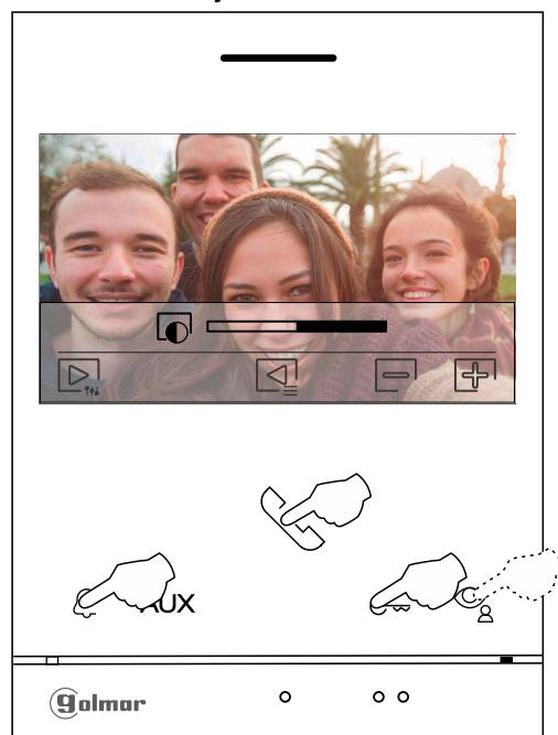
Presione el pulsador situado debajo del icono para salir del menú con el monitor en reposo (pantalla apagada).
