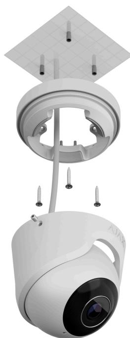
5. Coloque la carcasa de la cámara en el soporte, de manera que la lente de la cámara esté dirigida hacia la zona protegida. Fíjela apretando los dos tornillos del soporte con la llave hexagonal ( $\varnothing$  2 mm) del kit.
